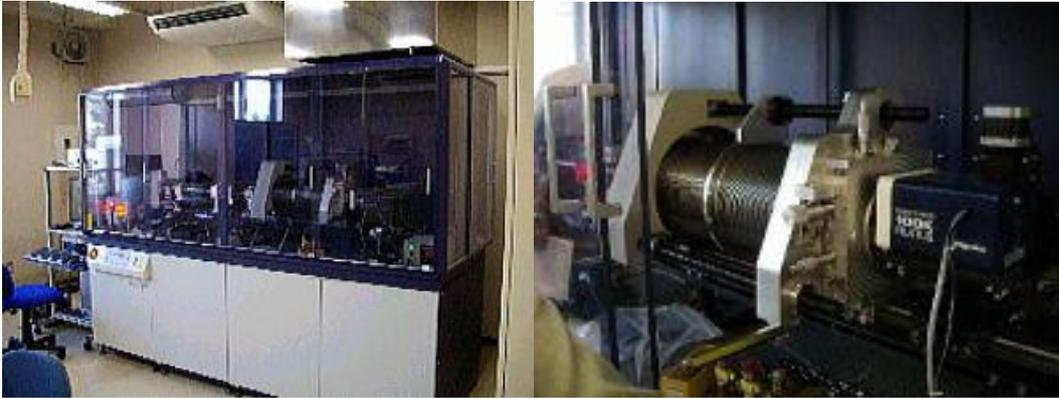
溶液中のミセルの回転半径、高分子のラメラ構造など数 nm～数十 nm スケールの構造を評価することができます。
