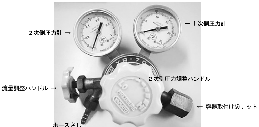
図7-4 圧力調整器
