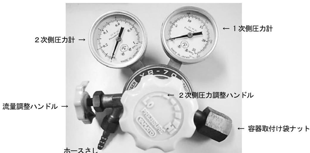
図7-4 圧力調整器
