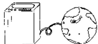
縁不良が生じた場合でも、機器のアースを正しく取ってあれば、漏電電流はアースを通過して地中を流れ、感電および漏電の危険性は少なくなる。
