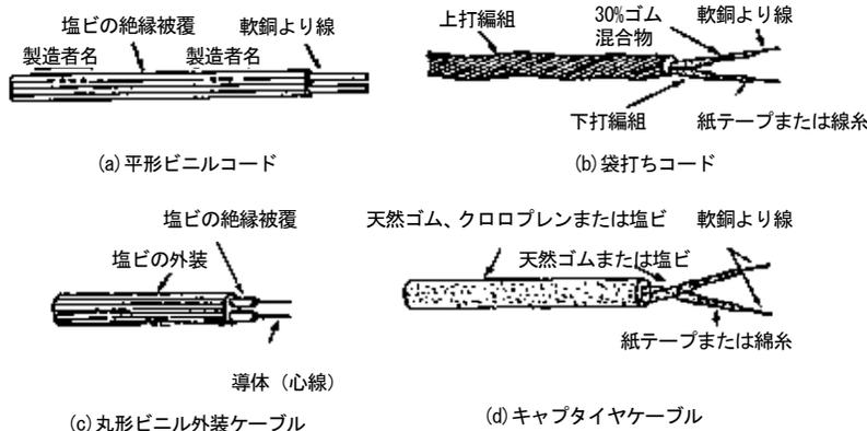
図5-1 電線、コード、ケーブル
