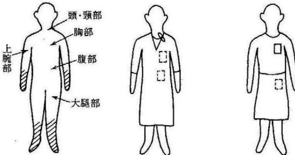
図6-3 ガラスバッジの装着箇所
