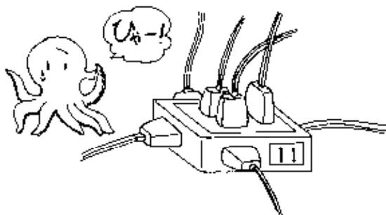
実験室には、通常、100Vコンセントと100V、200V交流電源の配電盤が設置されている。コンセントの定格電流は一般に15Aであり、容量が不足する場合や大電力を必要とする電気機器の電源は配電盤から直接取る必要がある。電気配線を行う際の注意事項を以下に示す。
