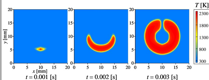
可燃性ガス中に渦輪(リング状に閉じた渦)や直線渦(直線状に伸びた渦)を作り、点火すると、渦に沿った方向に火炎が高速伝播します。このような現象は、大小さまざまな渦をもつ乱流燃焼場や大きなスワール流れをもつスワール燃焼場でも普通に起こると考えられています。したがって、この現象のメカニズムを詳しく解明し、それを予測・制御できるようになれば、自動車のピストン・エンジン、航空機のジェット・エンジン、火力発電所のガスタービン・エンジンなどの燃焼制御にも応用できるかもしれません。また防災・安全面から、火災旋風(巨大な炎の竜巻現象)などの予測・防止にも役立つかもしれません。
